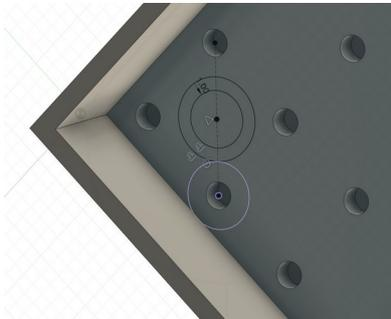
**Etape 8 /** Sélectionnez la forme précédemment créée afin de réaliser une extrusion, de hauteur 8,1mm
